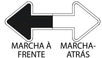
2. Premir e libertar o interruptor de Desativação do sentido de condução. Num espaço de 3 segundos, mover lentamente o comando de Condução no sentido da seta correspondente ao sentido de marcha desejado. A luz indicadora ficará intermitente durante o intervalo de 3 segundos até a função de condução ser selecionada.
