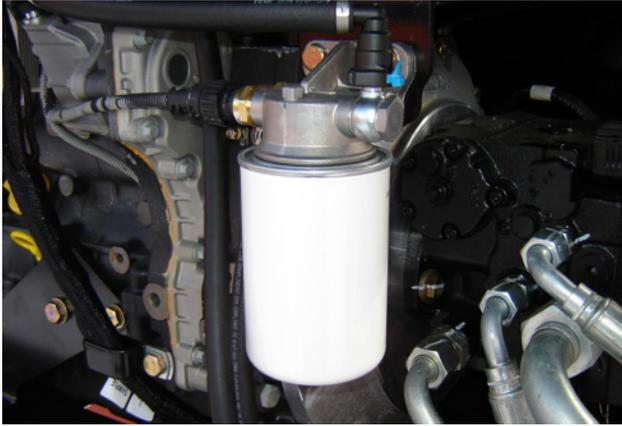
Ponto(s) de lubrificação — Elemento substituível
