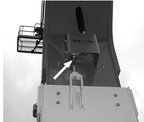
Figura 2-2. Interruptor de fim de curso horizontal da lança da torre
