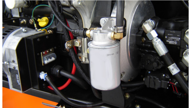
C. Filtro de Combustível — Deutz TD2.9 (No Motor)
