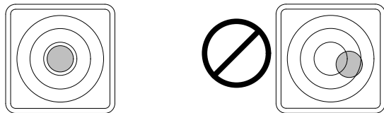
Nivelado NÃO — Nivelado Figura 3-15. Indicador de nível de bolha — Nível de máquina
