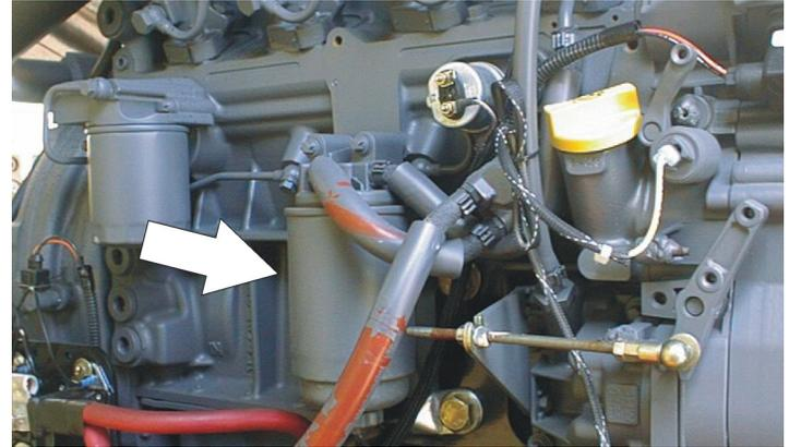
Ponto(s) de Lubrificação — Elemento Substituível
