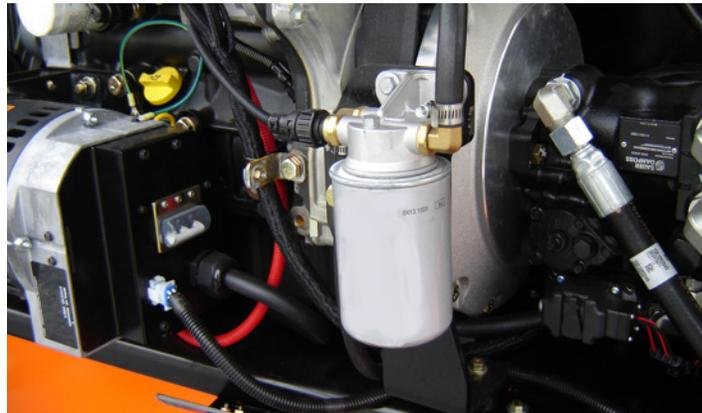
Ponto(s) de Lubrificação — Elemento Substituível
