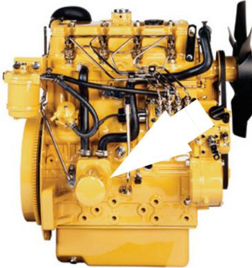
Pontos de Lubrificação - Tampa de Enchimento/Elemento Rosqueado (JLG N/P 7026855)
