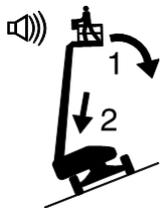
Se o alarme de inclinação soar com a plataforma em aclave:
