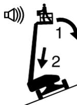
Se o alarme de inclinação soar com a plataforma em alicive:
