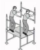
Durante a montagem use os pisos metálicos como apoio. Continua-se a montagem nesta ordem, até a altura estimada, instalando bloqueios diagonais a cada três metros de altura, revezando as direções das peças de travamento ou utilizando duas peças de travamentos posicionadas na forma de X.
