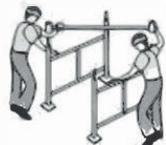
Com dois painéis e acessórios (sapatas fixas, reguláveis ou rodas) e uma diagonal, a montagem é iniciada. Deve-se montar uma diagonal a cada 3 metros trocando a posição, montando em "x" para travar o equipamento. Andaimos com rodas devem dispor de uma diagonal em "x" na base e as rodas sempre travadas.
